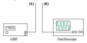
On visualise alors un signal sinusoïdal de fréquence f = 150 kHz.
