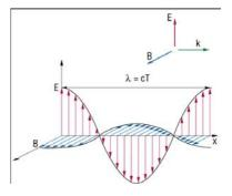
Une antenne émettrice émet des ondes électromagnétiques de même fréquence f que le signal électrique qui l'a généré.
