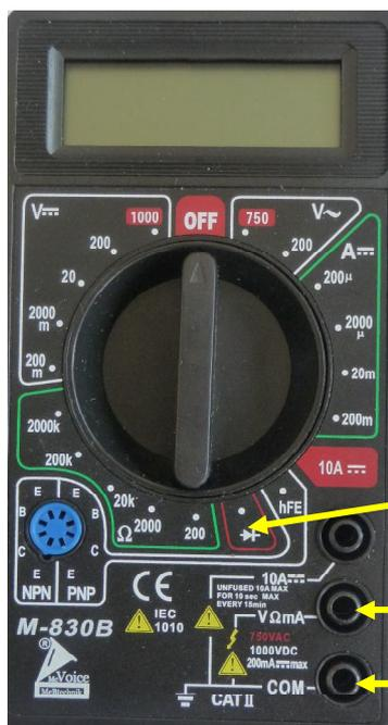
Calibre pour mesurer le tension d'une diode
